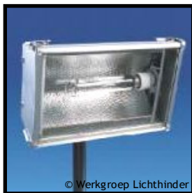
Figuur 8: een symmetrische lichtbundel heeft een symmetrische lichtbundel. Om het hele terrein te verlichten wordt dit type sterk geïnclineerd met veel lichthinder tot gevolg.
