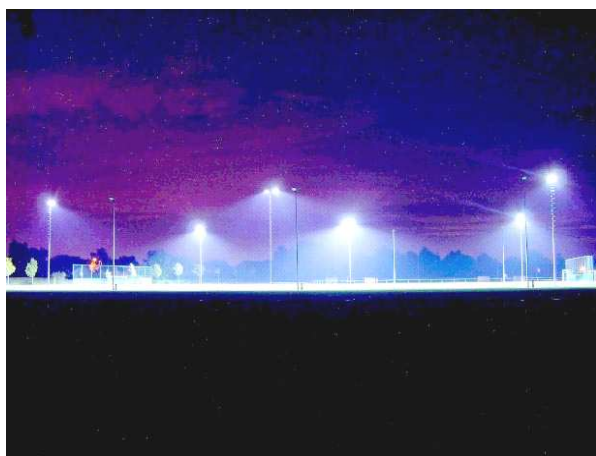
Figuur 9: door het gebruik van sterk asymmetrische terreinverlichting is er op dit veld in Sinaai geen probleem meer met lichthinder voor de omgeving. Dat zorgde niet alleen voor een betere verlichting van het voetbalveld maar tegelijkertijd voor een energiebesparing van 50%.
