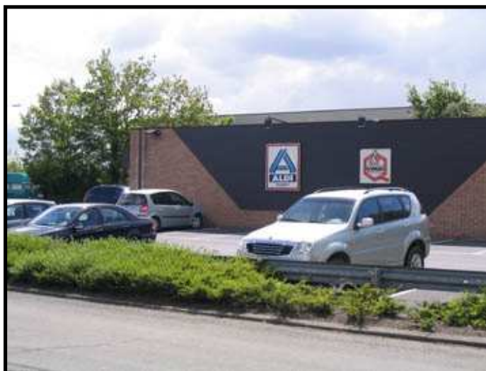
Figuur 6: Bij deze supermarkt worden enkel de logo's geaccentueerd - zoals de wetgeving het voorschrijft. Ook wordt er neerwaarts verlicht met minimale lichthinder tot gevolg.
