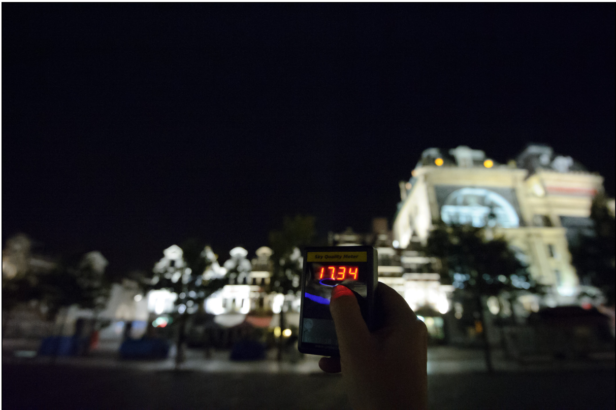
Afbeelding 2: De meter werd hier even uit zijn afscherming gehaald voor de foto. Meting van 17.34 op de Vrijdagmarkt. De hemel vertoont ernstige lichtverontreiniging (lage waarde op de SQM-L meter).
